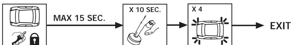
Bei nicht erfolgter Rückstellung der Override-Sicherung wird sie in jedem Fall, während des normalen Gebrauchs, nach 50 Aktivierungs-/Deaktivierungszyklen des Steuergehäuses automatisch rückgestellt.
